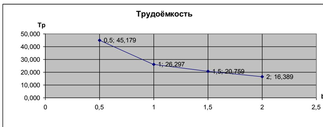
Рис.4. Зависимость снижения трудозатрат от увеличения шага между балками.
