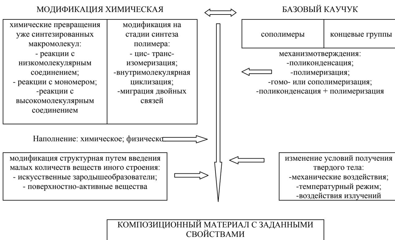
Рис.2 – Алгоритм проектирования каучуковых композиций
