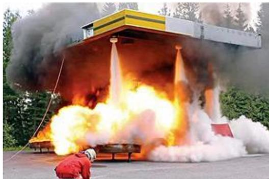
Рис. 5 Тушение огня инертными газами
