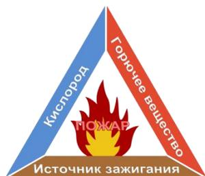
Рис. 1 Пожарный треугольник
