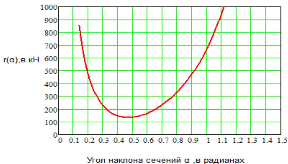
Рис. 3. График зависимости резерва прочности от углов наклона сечений.
